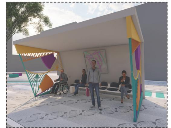
Os pontos de ônibus também trarão uma inovação e melhoria para o usuário. Quanto a sua estrutura serão placas de concreto pré-moldadas, fechados pelo mosaico metálico colorido, o que possibilita a entrada e vento e melhor conforto térmico.
