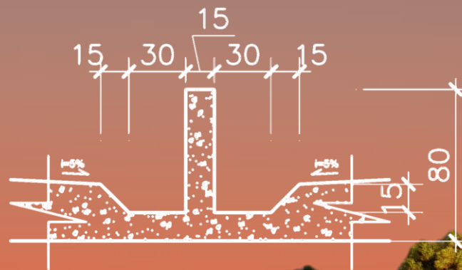
Detalhe da Viga-Laje em corte
