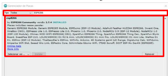
Figura 2 - Recorte da janela do Gerenciador de Placas, disponível através do endereço Ferramentas > Placa: "Arduino Uno" > Gerenciador de Placas
