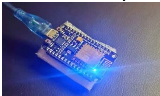
Figura 14 – Fotografia retirada da placa funcionando, com conexão USB ligada a porta do notebook e, com o LED Azul piscando indicando seu funcionamento.
