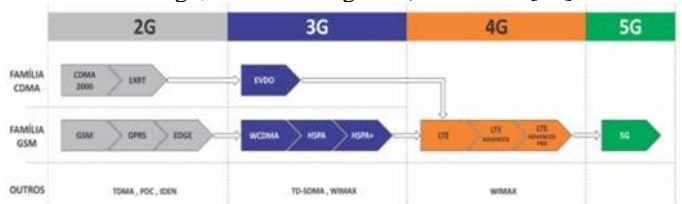
Figura 5 – Diagrama ilustrativo do desenvolvimento dos padrões de tecnologia móvel até o 5G. (Fonte: https://www.teleco.com.br/5g_tecnologia.asp )
