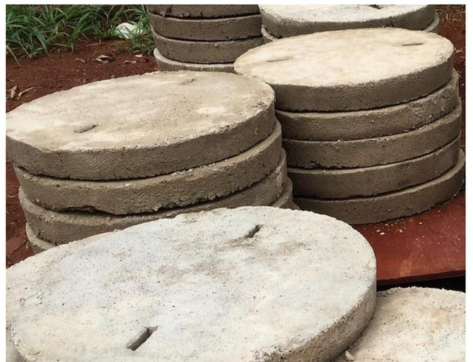
**Figura 22 – Aplicação dos agregados reciclados para fabricação de tampas de bueiros. Fonte: Página virtual da Usina de Reciclagem (2021)**
