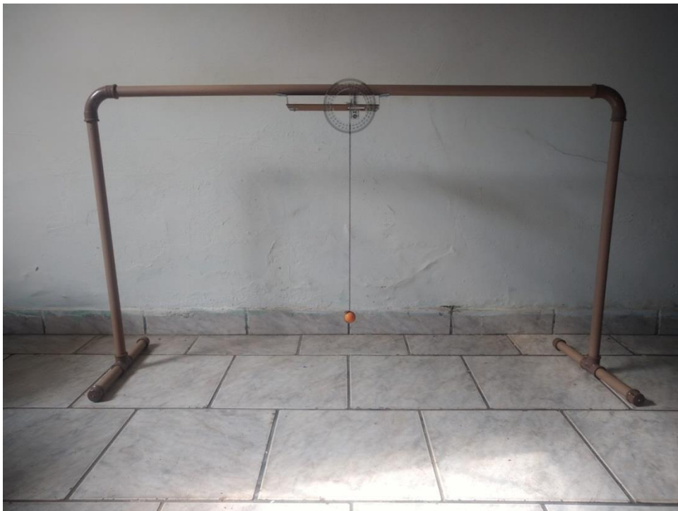
Figura 4.1 Aparato construído para medir o período de um pêndulo simples.
