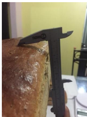
Figura 11 – Medição da altura por meio da utilização de paquímetro
