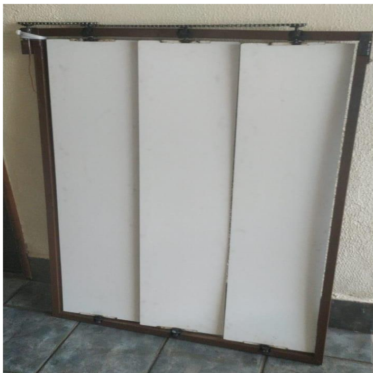
Figura 16 - Compensados e esqueleto da Janela
