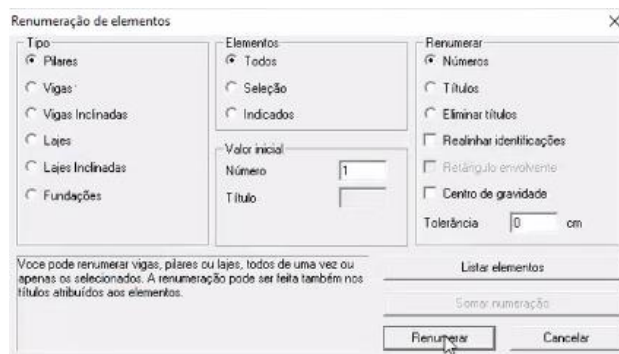
Figura 10 – Ferramenta de renumeração dos elementos no TQS
