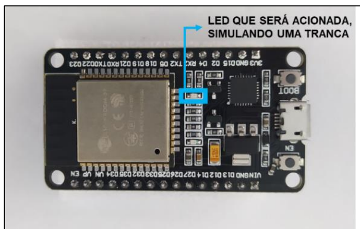
Figura 34 – Fotografia do Módulo ESP32 NodeMCU IoT WiFi e Bluetooth com marcação de LED que simula a tranca
