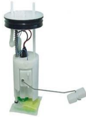
Figura 7 – Bomba de Combustível
