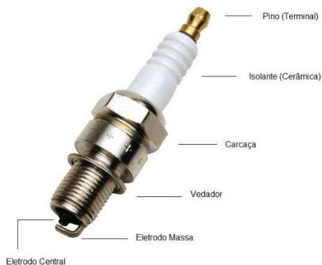
Figura 8.1 - Vela de Ignição
