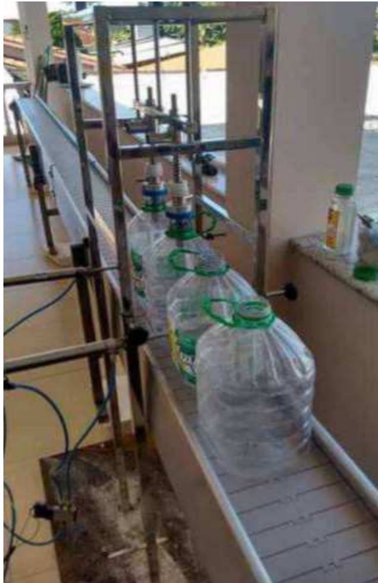
Figura 4: Esteira metálica – envase de suco de laranja
