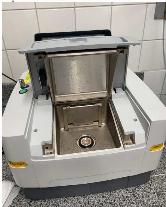
Figura 14: Parte interior do equipamento onde o pote metálico contendo a amostra no centro.
