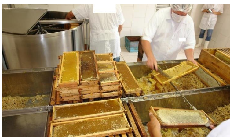
Figura 5 - Etapa de desoperculação dos favos de mel, caracterizada pela remoção dos opérculos para viabilizar as etapas subsequentes do processamento. Fonte: Arquivo pessoal, (2026).
