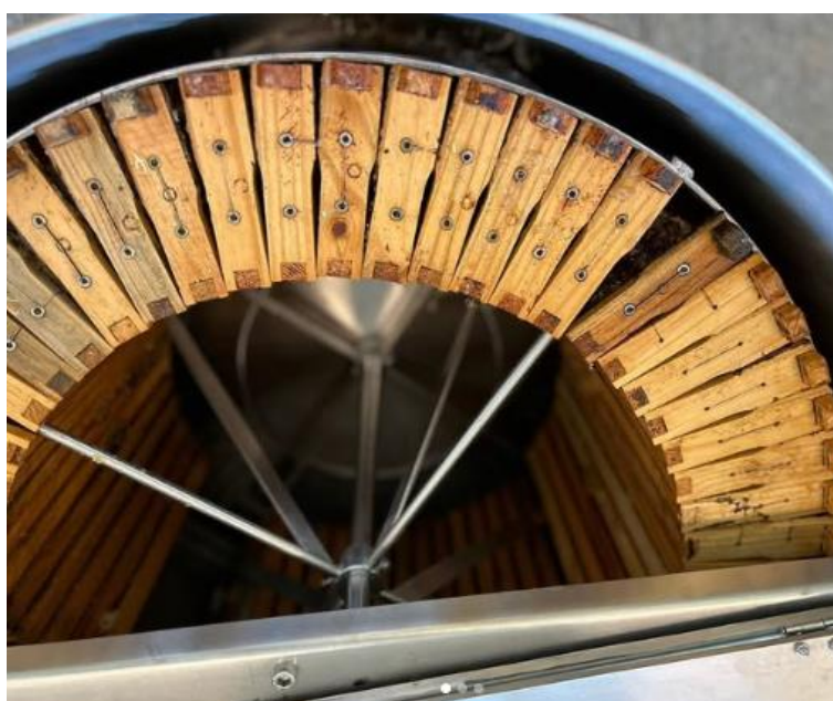
Figura 6 - Centrífuga utilizada na extração de mel, evidenciando o tambor rotativo com suportes para quadros de colmeia. O movimento centrífugo promove a extração do mel armazenado nos favos, sem danificar a estrutura dos quadros, permitindo sua reutilização na colmeia.
