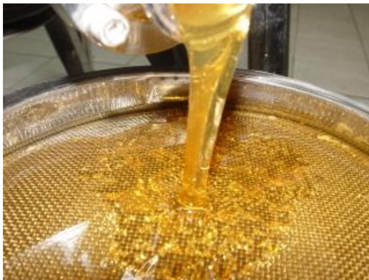
Figura 7 - Filtração inicial do mel após extração, evidenciando o escoamento do produto por peneira para remoção de impurezas, como fragmentos de cera e partículas sólidas, etapa obrigatória para a padronização e qualidade do mel. Fonte: Arquivo pessoal, (2026).
