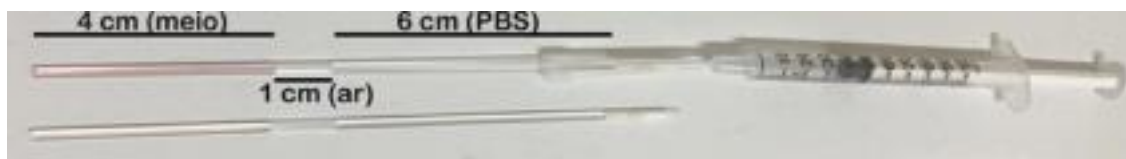
Figura 1 - Palheta de 0,25mL acoplada a ponteira e seringa para carregar as soluções (acima) e desacoplada (abaixo), contendo coluna de PBS, coluna de ar, e coluna de meio de reaquecimento
