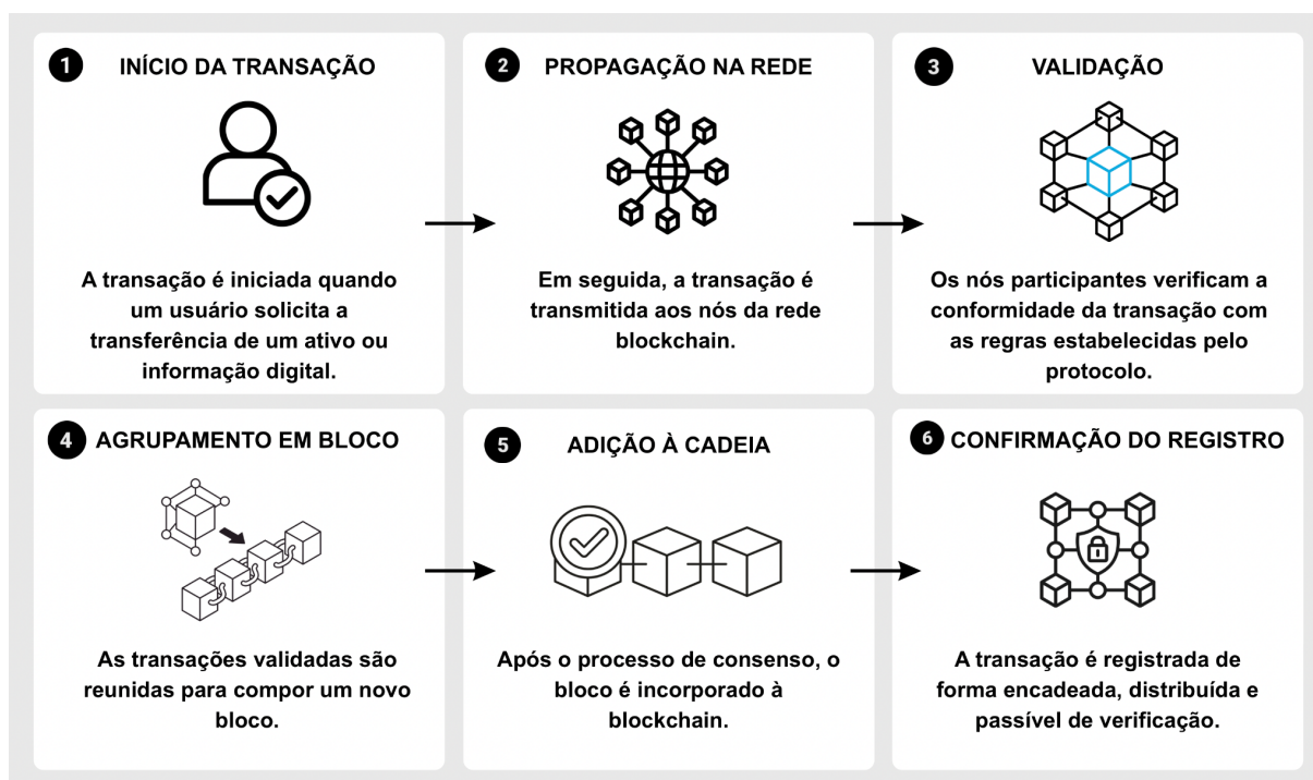
Figura 1 – Fluxograma simplificado mostrando os 6 passos de uma transação na blockchain .
