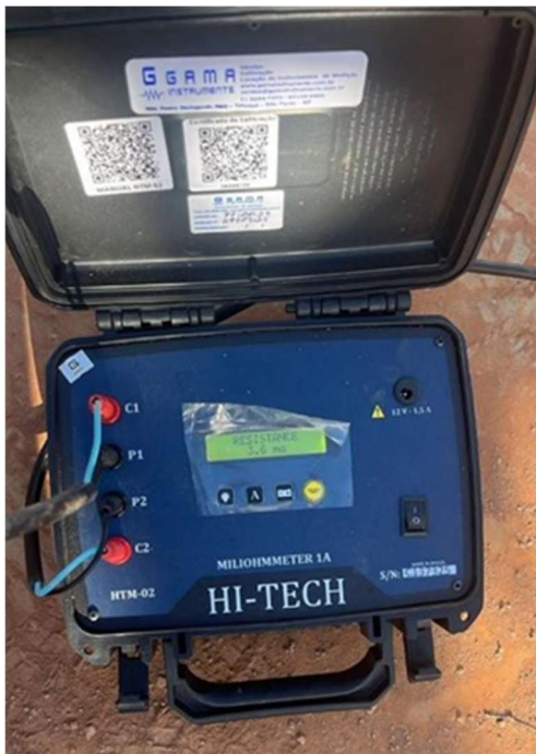
Figura 10. Medição da malha de aterramento com o Terrômetro. Fonte: Foto do autor (2026).
