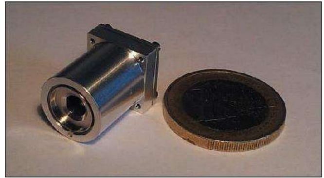
Figura 16. Foto de um Propulsor NanoFEED Comparado com Uma Moeda de 1€.
