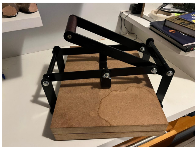
Figura 15: Prensa utilizada na linogravura para gravar o material escolhido.
