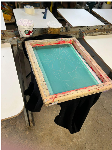
Figura 34: Tela da estampa frontal pronta para a impressão com as correções já feitas.
