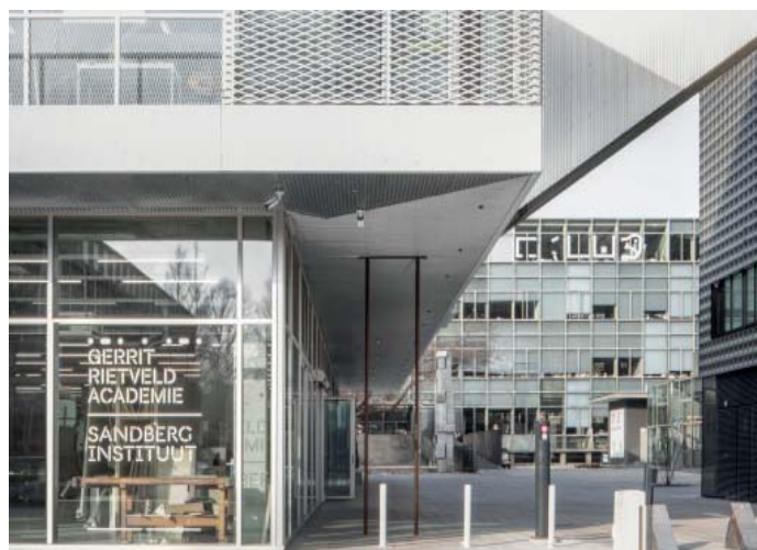
Imagem 17: Balanço do primeiro pavimento.
