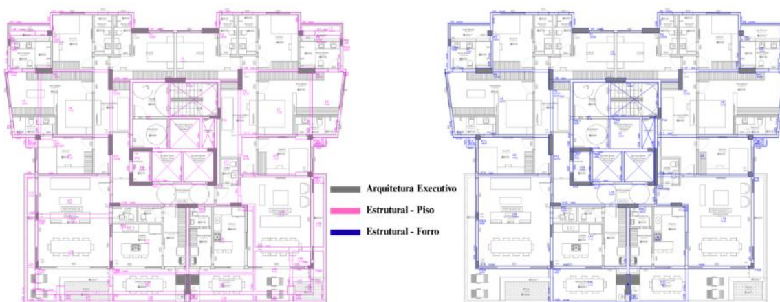
Figura 1: Sobreposição do Projeto de Arquitetura Executivo X Projeto Estrutural – AutoCAD
