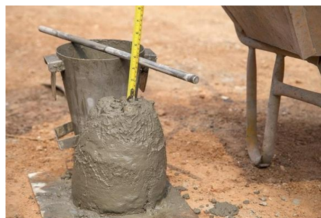
Figura 2 – Ensaio de slump test [18].
