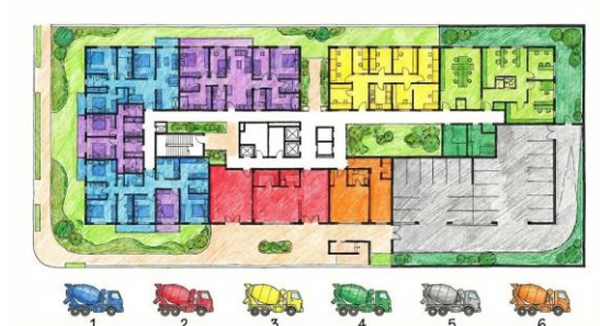
Figura 3 – Mapeamento do Concreto. Autores (2025).
