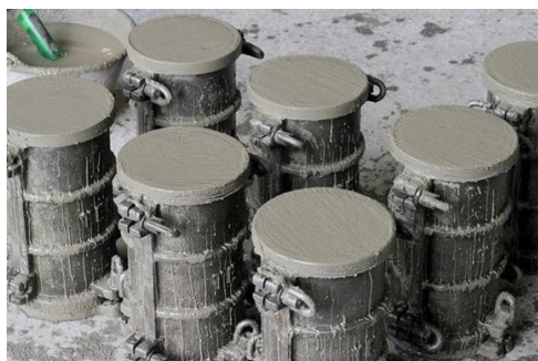
Figura 1 – Moldagem dos corpos de prova de concreto [18].
