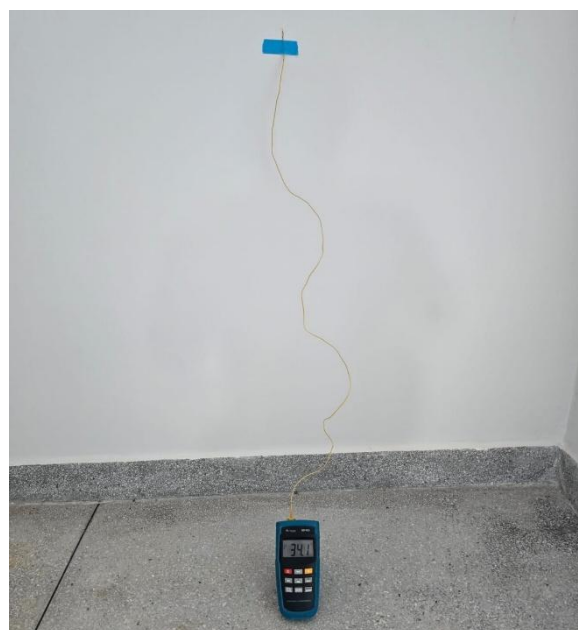
Figura 10 – Altura de Posicionamento do Termopar – Face Interna.
