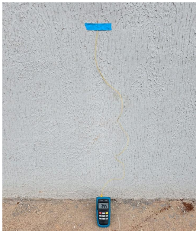
Figura 09 – Altura de Posicionamento do Termopar – Face Externa.
