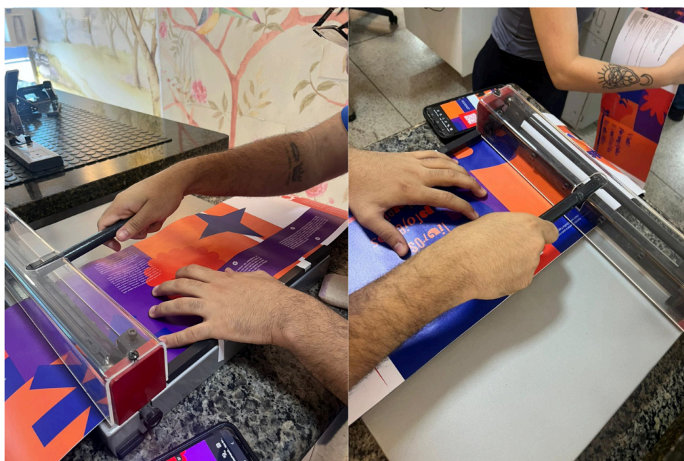
Figura 23: processo de vincagem e sanfona
