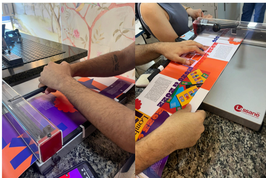
Figura 22: processo de vincagem
