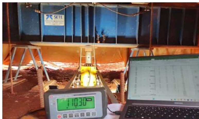
Figura 9: Leitora da célula de carga e sistema de aquisição dos dados.
