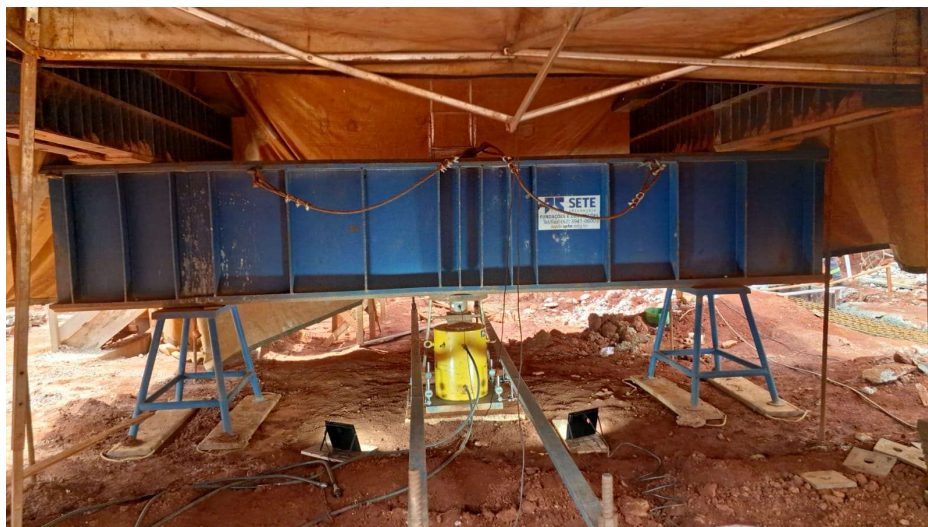
Figura 7: Sistema de reação do ensaio PCE montando
