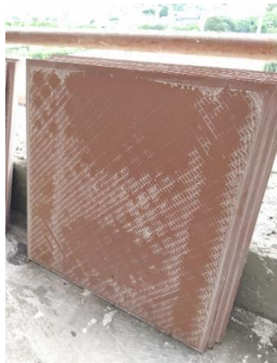
(d) Tardo do da peça sujo e com presença de pó
