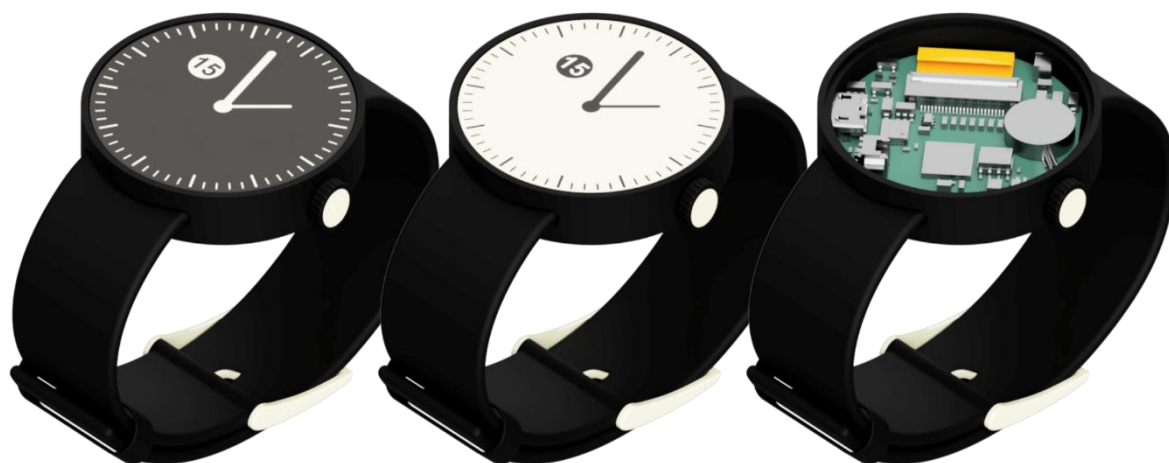
Figura 5 – Variação da cor de tela E-ink e detalhe da adaptação de microcontrolador ESP32-S3, para o projeto.
